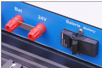
Puente de Conexión / Interruptor de la Batería
