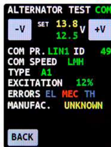
Fig. 7. Pantalla de diagnóstico de alternadores tipo “COM”.
