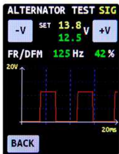
Fig. 8. Tela de diagnóstico de alternadores quando um dos seguintes tipos de alternadores é selecionado: "SIG", "RLO", "RVC", "C KOR.", "P/D", "C JAP."
