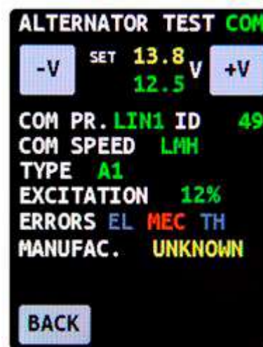
Fig. 7. Tela de diagnóstico de alternadores do tipo “COM”.
