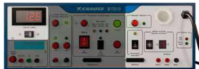
O módulo de teste de Módulos e Bobinas de Ignição opera somente em 12 Volts. Para poder entrar neste módulo é necessário que o Testador esteja na condição inicial, ou seja, a fonte em 12 Volts e o módulo de teste de reguladores desabilitado.
