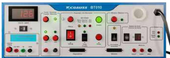
O **Testador de Autopeças Eletrônicas BT010** foi especialmente projetado para testar os componentes dos sistemas elétrico e eletrônico de veículos motorizados.
