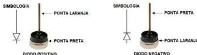
Para testar este tipo de diodo, siga o procedimento:
